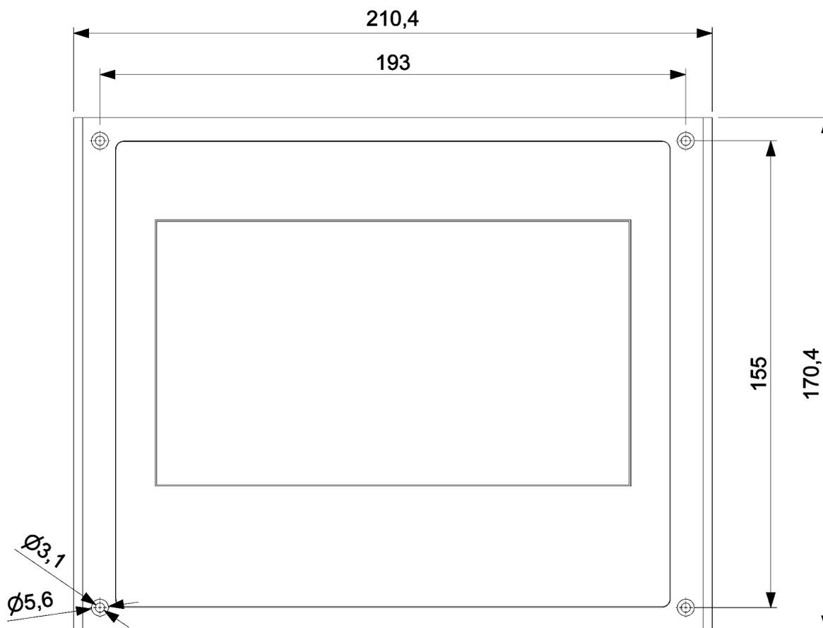
I computer Posyc 3401/2 devono essere fissati su un pannello stabile e rigido dotato di foro filettato in metallo 4xM3, min. 1,5 mm di profondità. Utilizzare viti 4xM3x10mm Fe/Zn (non a testa svasata), min. classe 8.8, serrato a 1 Nm.
