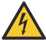
Hautes capacités présentes à l'intérieur de l'appareil. Risque de choc électrique; attendez au moins 600 secondes (10 minutes) après la mise hors tension. Les câbles et les connecteurs ne doivent pas être connectés ou déconnectés avant la fin du temps indiqué.
